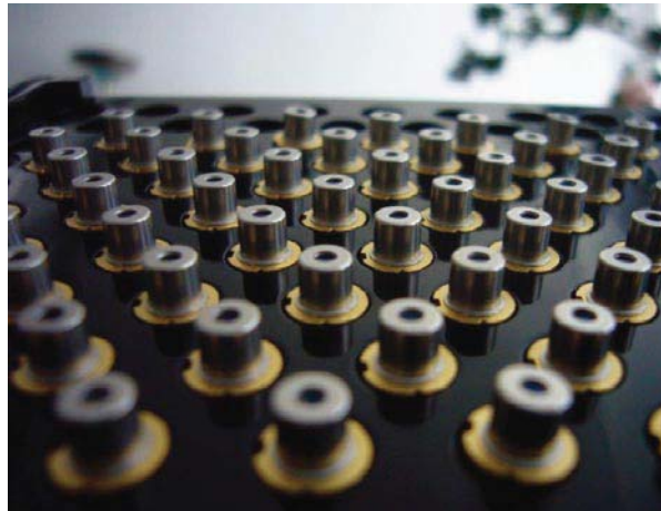
300 mW的連續單模雷射二極體於結構光的應用
