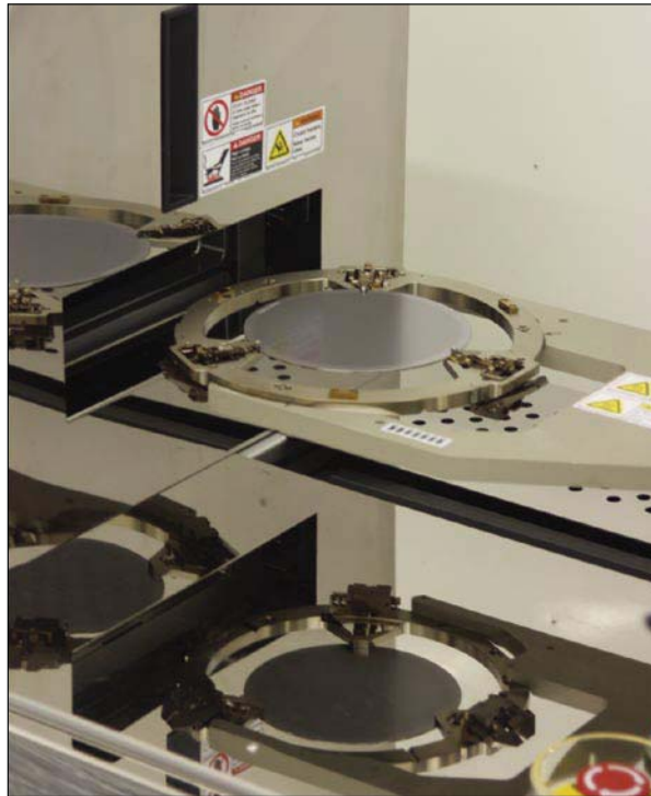
由於矽會吸收LED發出的光，所以需要在磊晶晶圓與載板結合的製程上將其移除。
