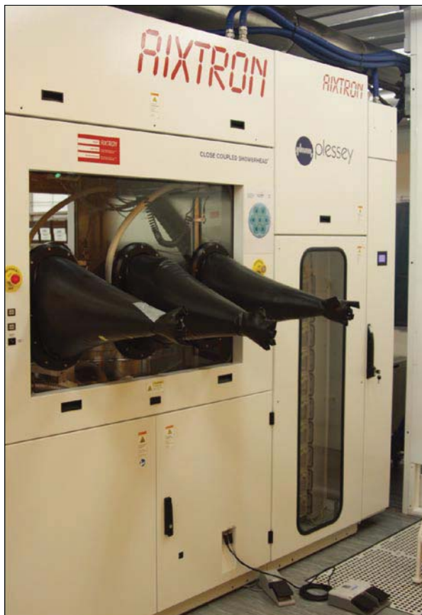
Plessey 的砷基氮化鎵LED是用Aixtron的反應器所生產出來的，該反應器可容納七片6英寸的晶圓，且設置許多即時監控的裝置，用於測量晶片的曲率以及溫度。
