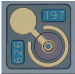
Oclaro已經研發出了10 Gbit/s的VCSEL晶片，用於在非真空密封裝及高速光學互連上
