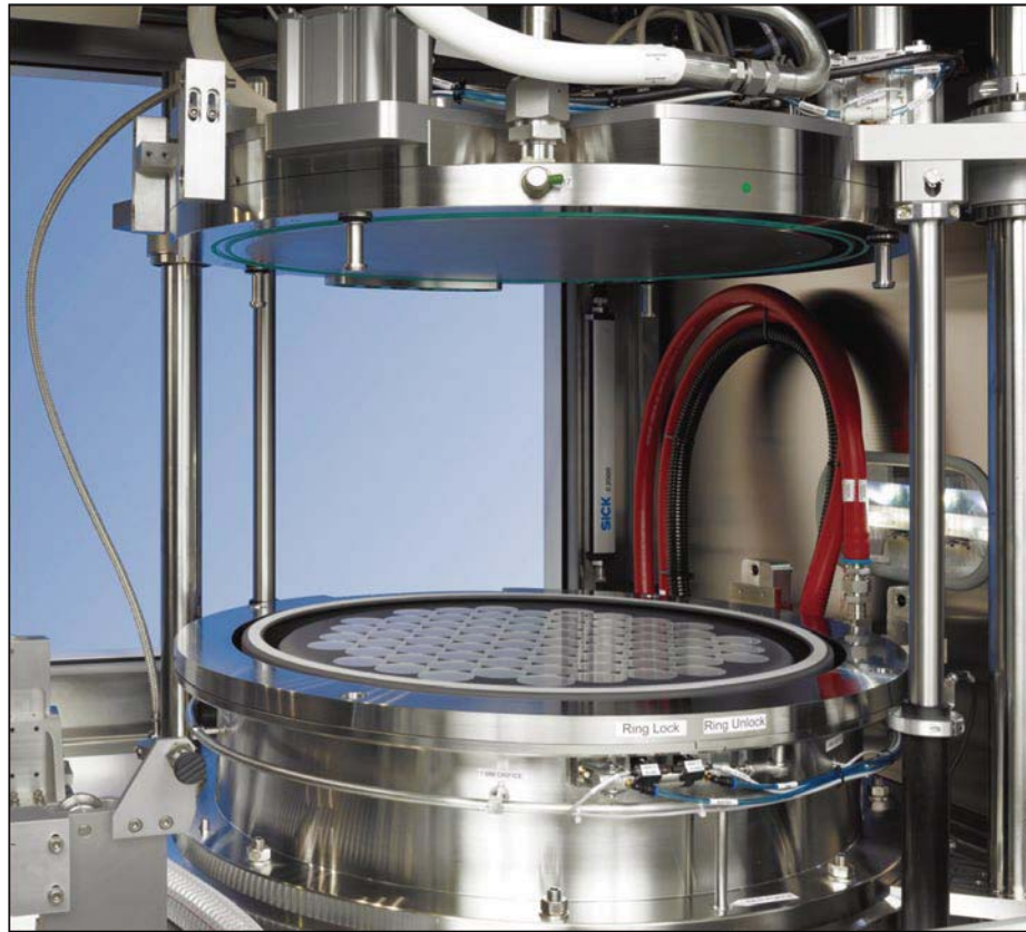
圖三：69 x 2英寸晶圓配置的CRIUS II-L反應器
